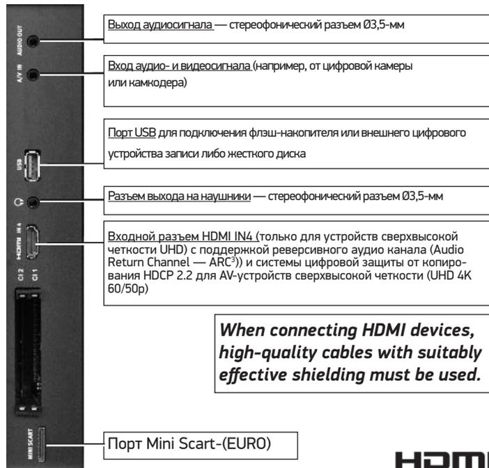
Выход аудиосигнала — стереофонический разъем Ø3,5-мм
