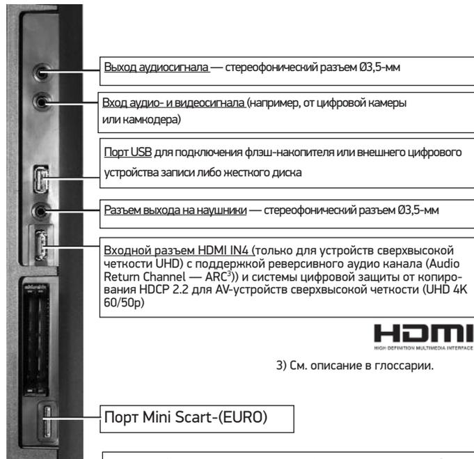
**При подключении устройств HDMI необходимо пользоваться только высококачественными кабелями с экранированием соответствующей эффективности.**
